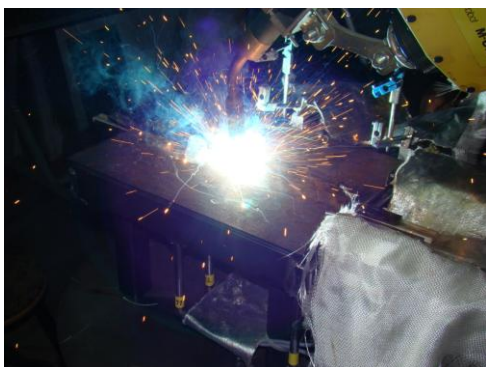
Vollmechanisierter Roboter MAG-Schweißprozess am Stumpfstoß
