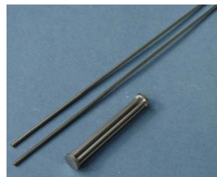
Abb. 9 Kapillaren und Kapillarbündel-Modul (10 cm Länge)
