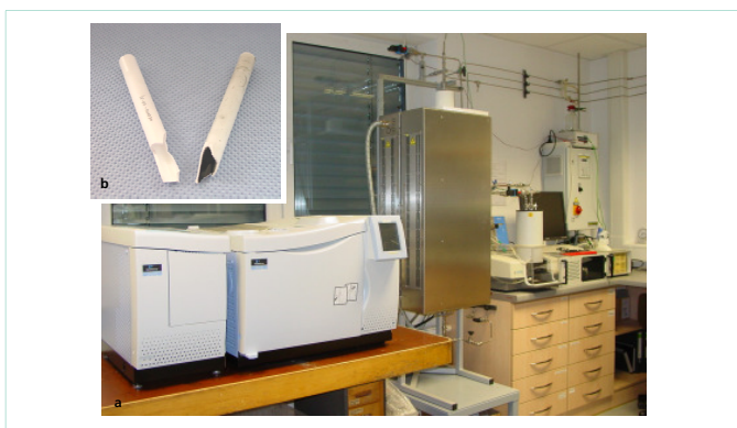
Bild 1 a) CVD-Anlage zur Herstellung von CNT-Schichten. b) CNT-Schicht abgeschieden auf der Innenseite eines \text{Al}_2\text{O}_3 -Einkanalrohres.
