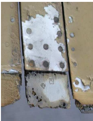
Detail eines korrodierten Flugzeugträgers aus Magnesium
