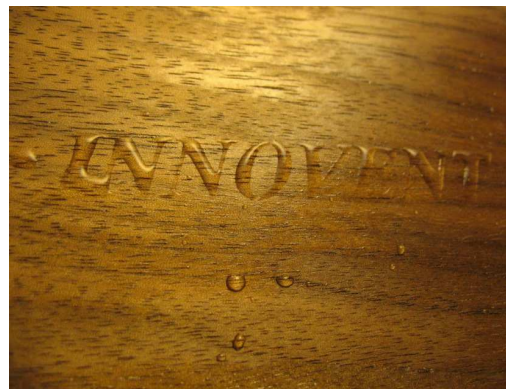
Hydrophil-hydrophob beschichtete Holzoberfläche mittels Atmosphärendruckplasma
