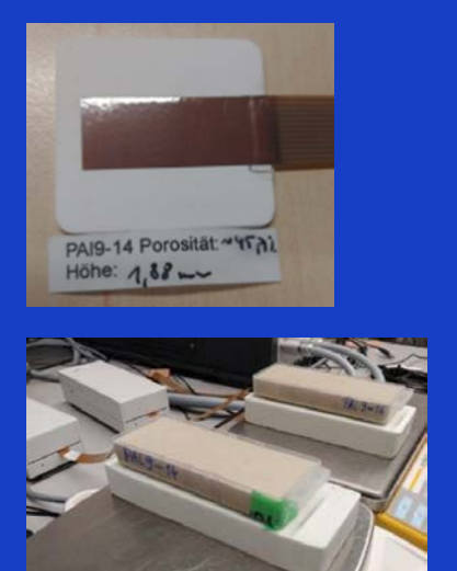
Permittivitäts-Signal von Finger-Sensor (PAI9 + Silikonklebeschicht) bei Austrocknung von Fließ-Estrichproben
